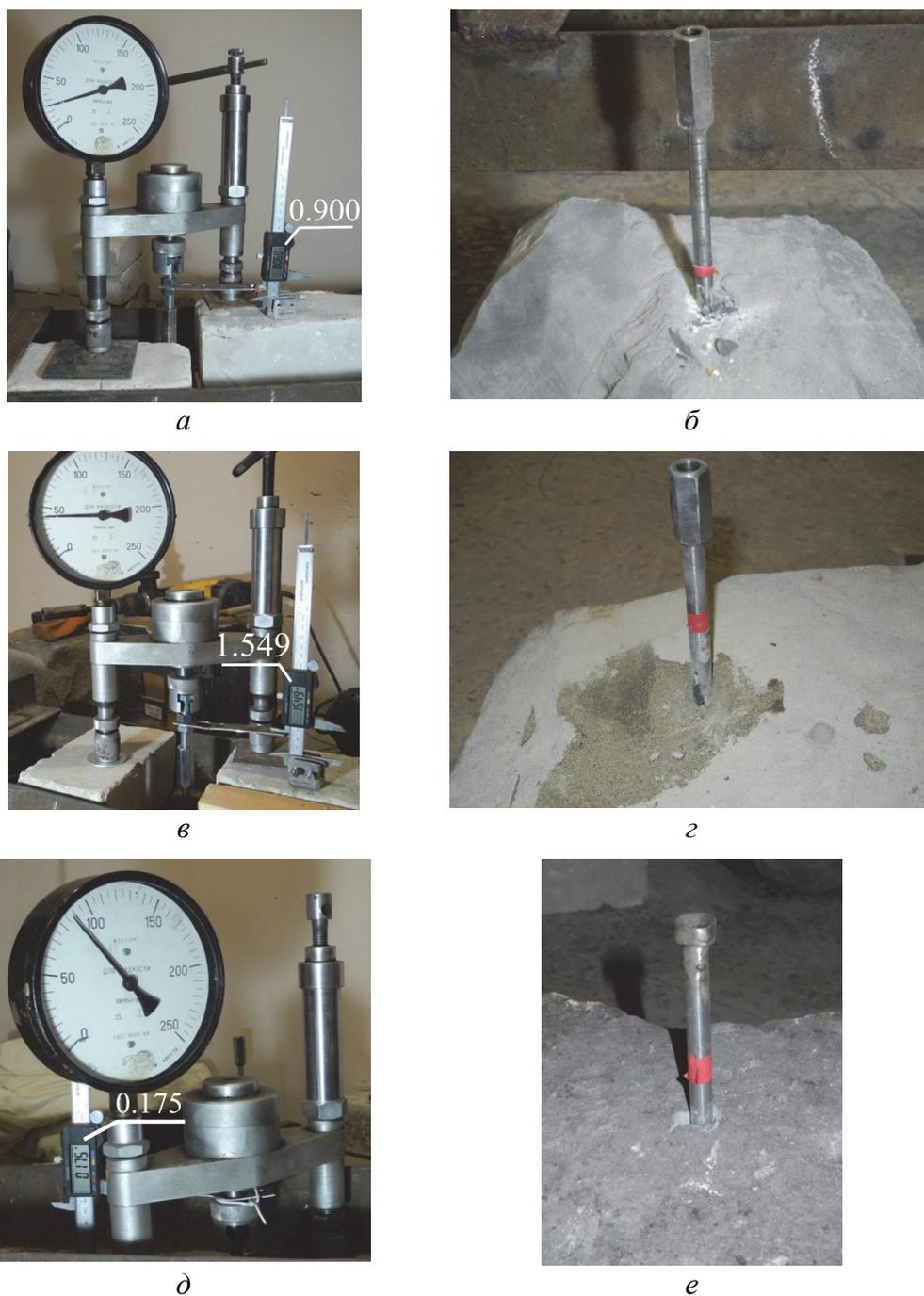
**Рис. 3.** Состояние моделей из глинистого сланца (№ 3), песчаного сланца (№ 14) и песчаника (№ 17) на момент начала (*а, в, д*) и окончания (*б, з, е*) испытаний
