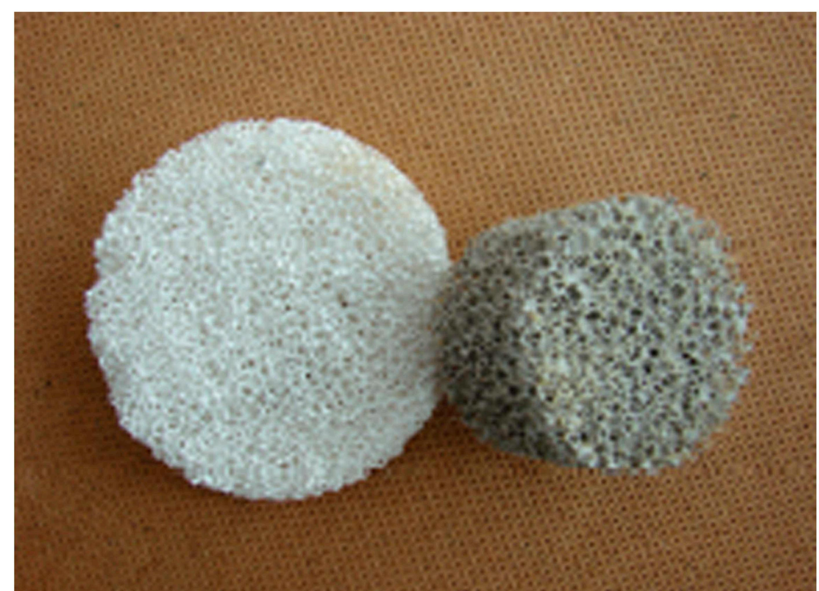
**Описание:** технология позволяет получать керамику на основе диоксида циркония и оксида алюминия с заданной пористостью в диапазоне 10-90%.
