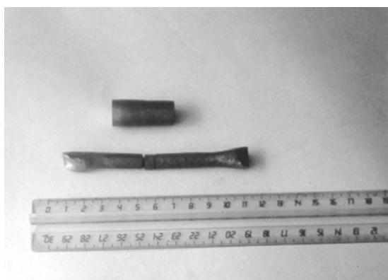
Рис. 5. Внешний вид образцов из вольфрама после ИПД
