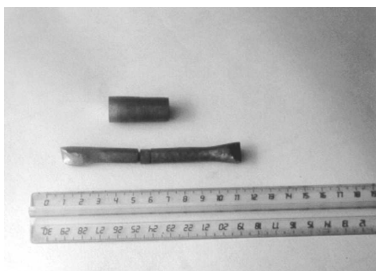
Рис. 5. Внешний вид образцов из вольфрама после ИПД
