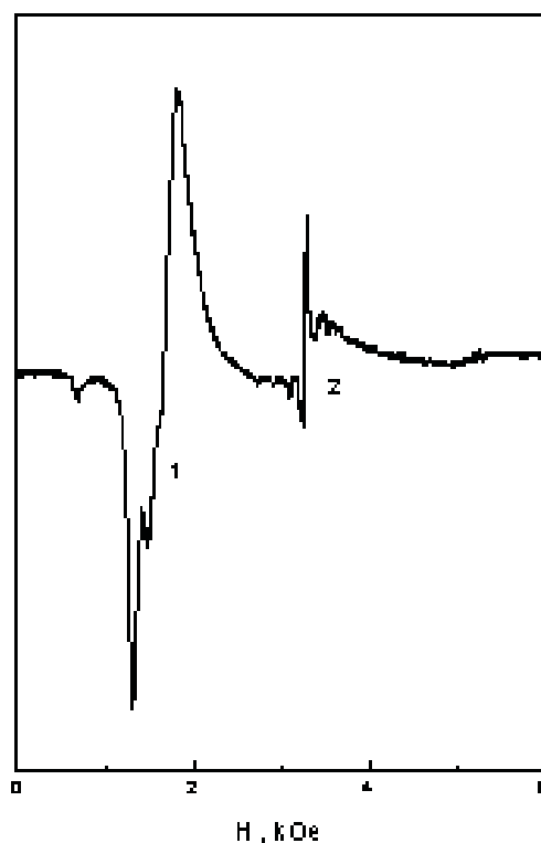
Рис. 3.29. Спектр ЭПР ионов \text{Fe}^{3+} в каолините : T = 4.2 \text{ K} , H // Z .
