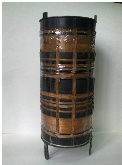
Рис. 3. Обмотки компенсации градиентов магнитного поля
