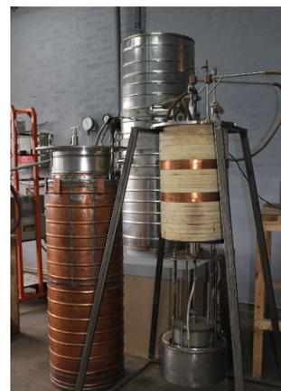
Рис. 2. Экспериментальная установка для испытания соленоидов
