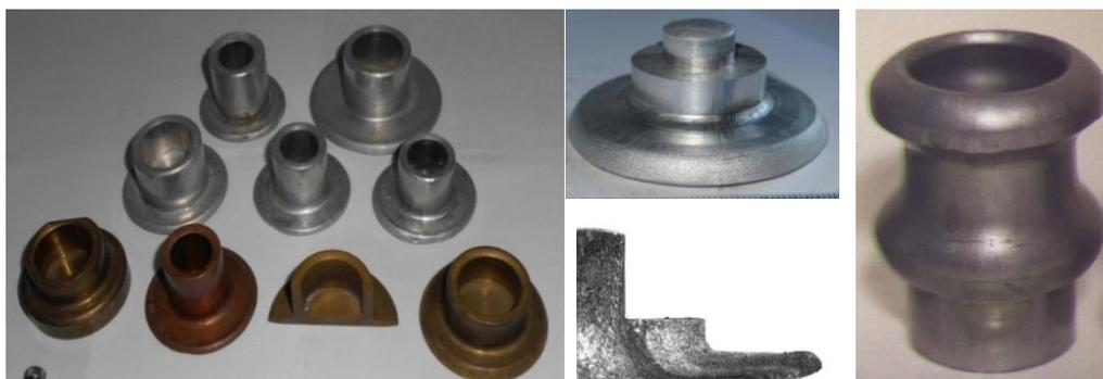
Рис. 8. Детали, изготовленные радиально-обратным выдавливанием
