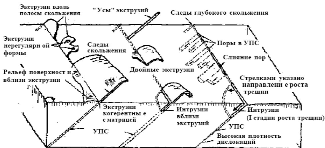
Рис. 7.28. Экструзии (выступы) и интрузии (впадины) в устойчивых полосах скольжения (УПС) при циклическом деформировании.
