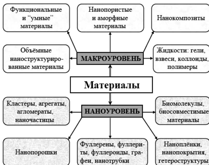
Рис. 7.1. Классификация ультрадисперсных материалов.
