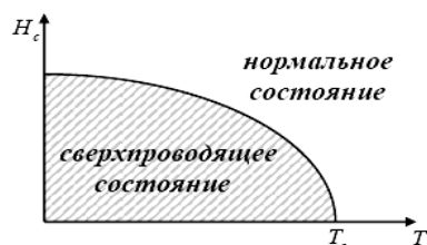
Рис. 5.27. Зависимость критической напряжённости магнитного поля от температуры.
