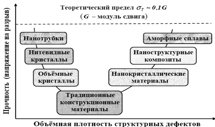
Рис. 7.5. Зависимость прочности макроматериала от концентрации дефектов структуры.
