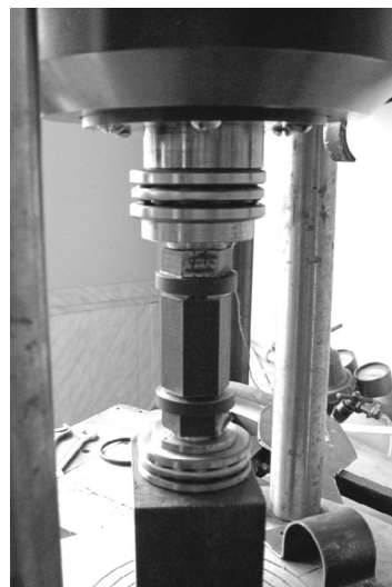
Рис. 1. Устройство для 3D-РТ деформации: матрица и скошенные поршни
