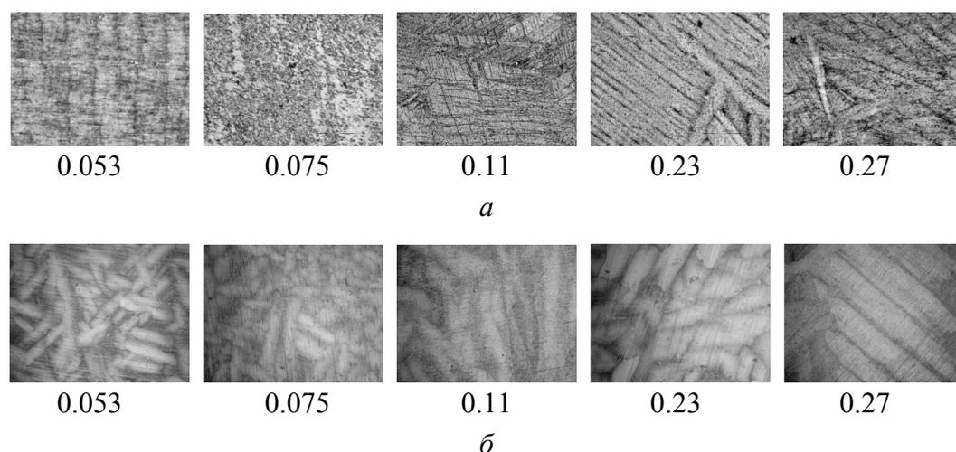
**Рис. 3.** Микроструктура слитков титана с различным содержанием кислорода: *a* – без отжига ( $\times 200$ ), *б* – после отжига ( $\times 100$ ) (цифры под рисунками указывают концентрацию кислорода в mass%)
