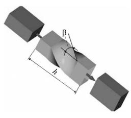
**Рис. 1.** Схема обработки винтовой экструзией
