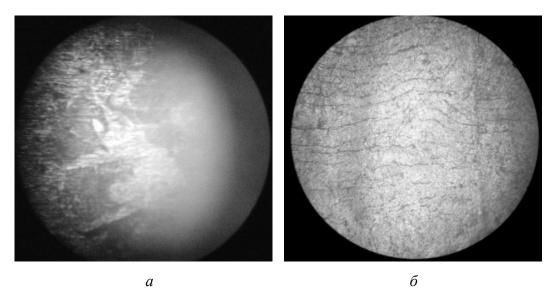
**Рис. 2.** Структура ВТ1-0 в исходном состоянии (a) и после 4 проходов ВЭ ( $\delta$ ). Увеличение ×600, при фотографировании увеличено в 2 раза
