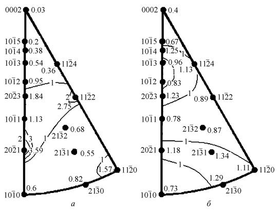
**Рис. 3.** Экспериментальные ОПФ сплава ВТ1-0: a — исходный образец,  $\delta$  — после ВЭ (перпендикулярно оси экструзии)
