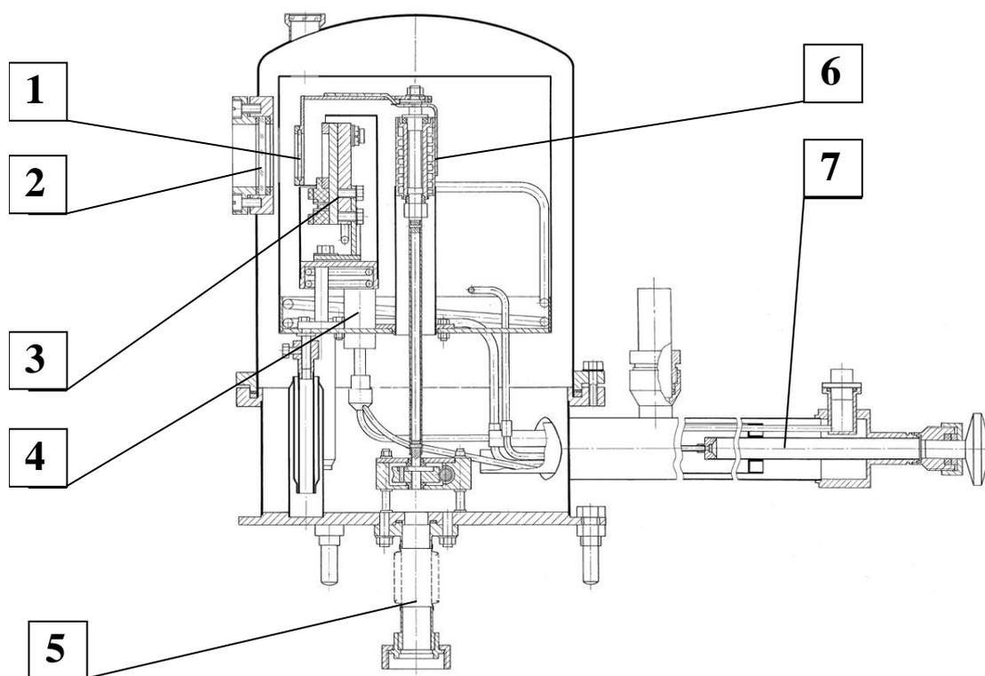
**1-Кассета с фильтрами, 2 - Окно-фильтр входной, 3 - Держатель образца, 4 - Теплообменник системы регулирования температуры образца, 5 - Узел стыковки с вакуумной системой предварительной откачки, 6 -Теплообменник системы регулирования температуры кассеты с фильтрами, 7 - Стыковочный узел подачи хладагента**
