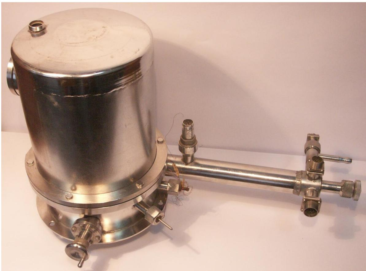
**Криостат ФПУ предназначен для решения всего комплекса задач исследования и аттестации характеристик фоточувствительных материалов, фотоприемников и фотоприемных устройств \ ФПУ \ в диапазоне температур 10-300К в видимой и инфракрасной области спектра излучений**
