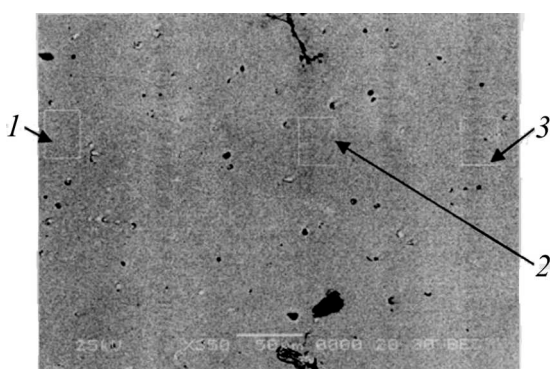
Рис. 3. Образец, полученный методом жидкофазного спекания
