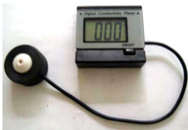
Рис.7.4. Прибор для измерения удельного сопротивления крови
