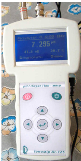
Рис. 4.3. Прибор для измерения кислотно-щелочного равновесия
