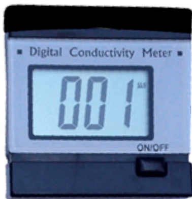
Рис. 4.1. Прибор для измерения электропроводности воды PKL-1382B
