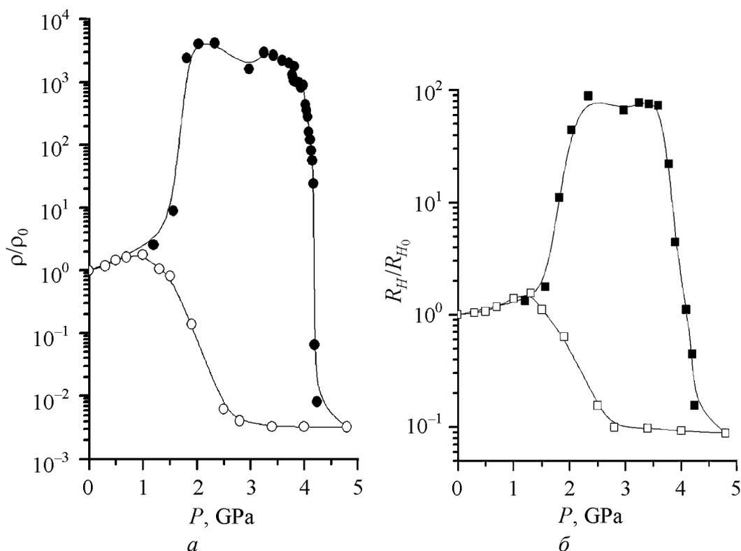
**Рис. 1.** Барические зависимости приведенных к атмосферному давлению удельного электросопротивления (а) и коэффициента Холла (б) в  $n$ -CdTe ( $n = 7.7 \cdot 10^{16} \text{ cm}^{-3}$ ,  $\mu = 760 \text{ cm}^2 \cdot \text{V}^{-1} \cdot \text{cm}^{-1}$ ): ●, ■ – подъем давления; ○, □ – сброс
