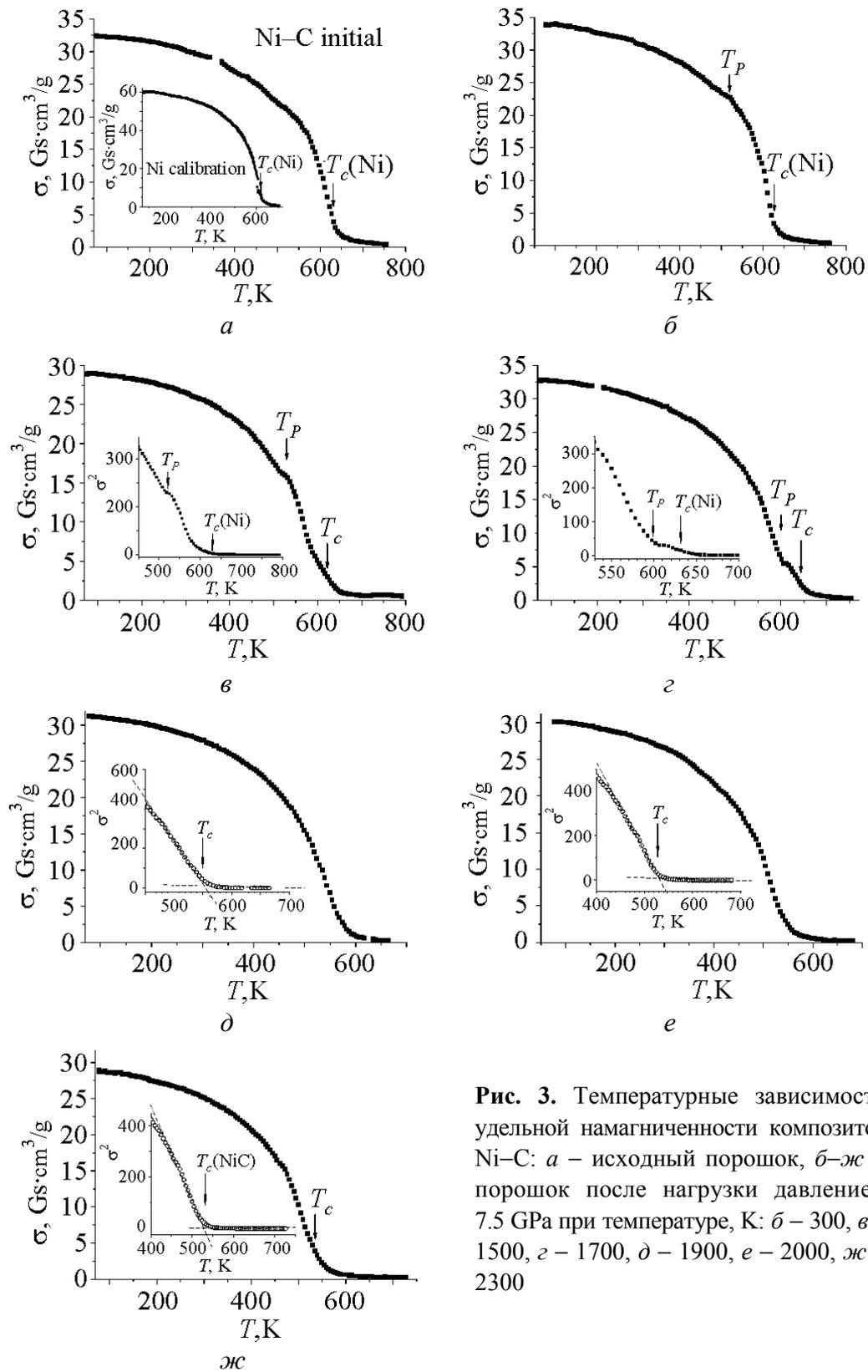
**Рис. 3.** Температурные зависимости удельной намагниченности композитов Ni-C: а – исходный порошок, б–ж – порошок после нагрузки давлением 7.5 GPa при температуре, К: б – 300, в – 1500, г – 1700, д – 1900, е – 2000, ж – 2300
