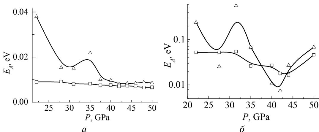
**Рис. 2.** Барические зависимости энергии активации образцов с 40- (а) и 90%-ным (б) содержанием ОУНТ для двух температурных интервалов:  $\square$  –  $T < 250$  К,  $\Delta$  –  $T > 250$  К
