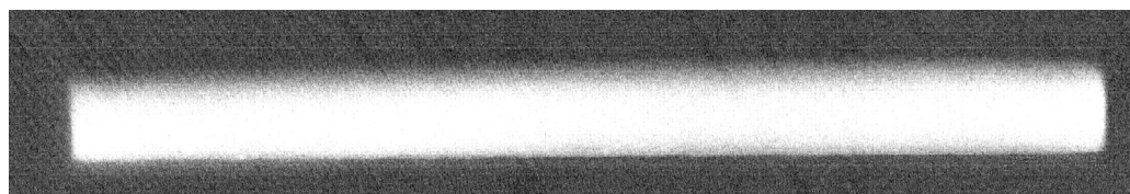
Рис. 5. Рентгеноскопический снимок УМЗ-образца диаметром 11 mm из сплава ВТ1-0, полученного РКУП ( e = 9 ) и последующей экструзией ( e = 1.2 )
