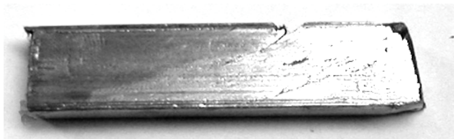
Рис. 6. Заготовка после 20 циклов РКУП по маршруту Вс
