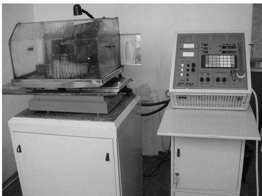
Рис. 1. Станок для электроэрозионной обработки модели ZAPbp-95d
