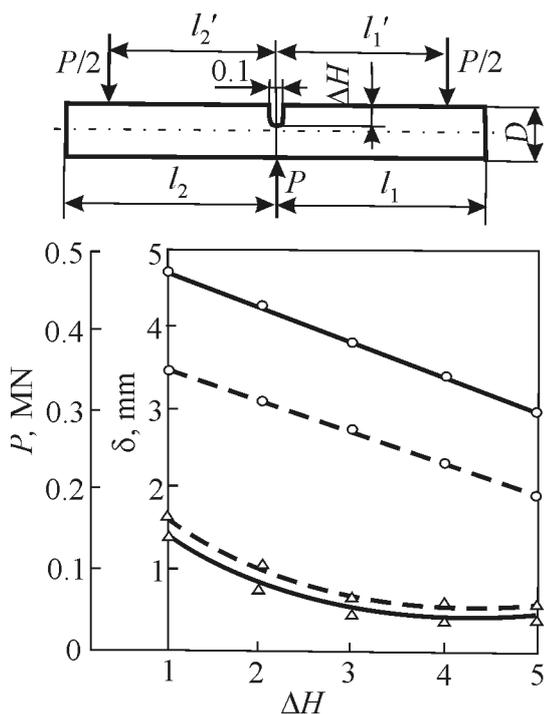
**Рис. 4.** Зависимость усилия ломки и величины отклонения траектории трещины от глубины электроэрозионного надреза для сталей ШХ15 НВ370 (—) и 45 НВ250 (---): ○ —  $P$ , Δ —  $\delta$
