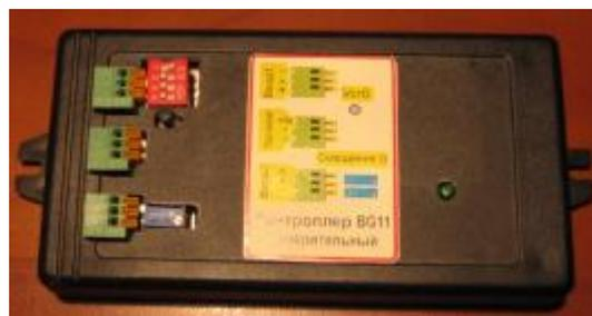
**Источник питания +5/10 В для питания цепей датчиков сигналов.****USB 2.0 порт.****Питание +5 V – от USB шины.****Объединение контроллеров в многоходовые измерительные системы.****Конструктивно контроллер выполнен как отдельное корпусное изделие.****1. Назначение**
