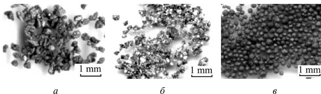
Рис. 4. Вид частиц порошков передающей среды: а – порошок графита марки ГЭ; б – смесь порошков состава (60% ГЭ + 40% BN); в – порошок графита марки 9400
