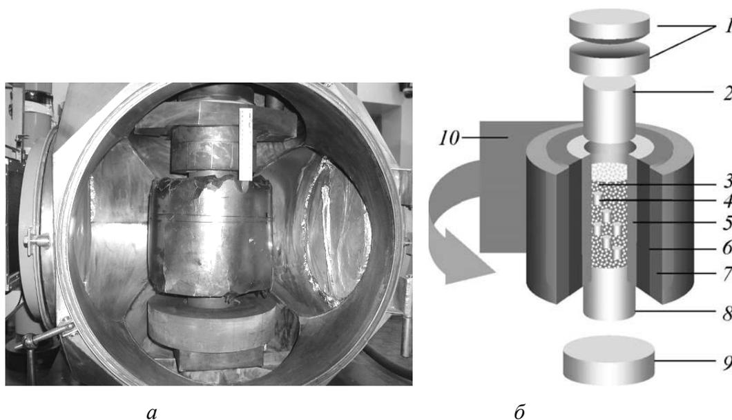
**Рис. 2.** Внешний вид (а) и конструкция (б) пресс-формы: 1 – сферическая пара; 2, 8 – верхний и нижний пуансоны; 3 – порошковая передающая среда; 4 – преформы; 5 – графитовый цилиндр пресс-формы; 6 – УУКМ силовой цилиндр для упрочнения пресс-формы; 7 – графитовый войлок (теплоизоляция); 9 – нижняя опора; 10 – графитовая фольга
