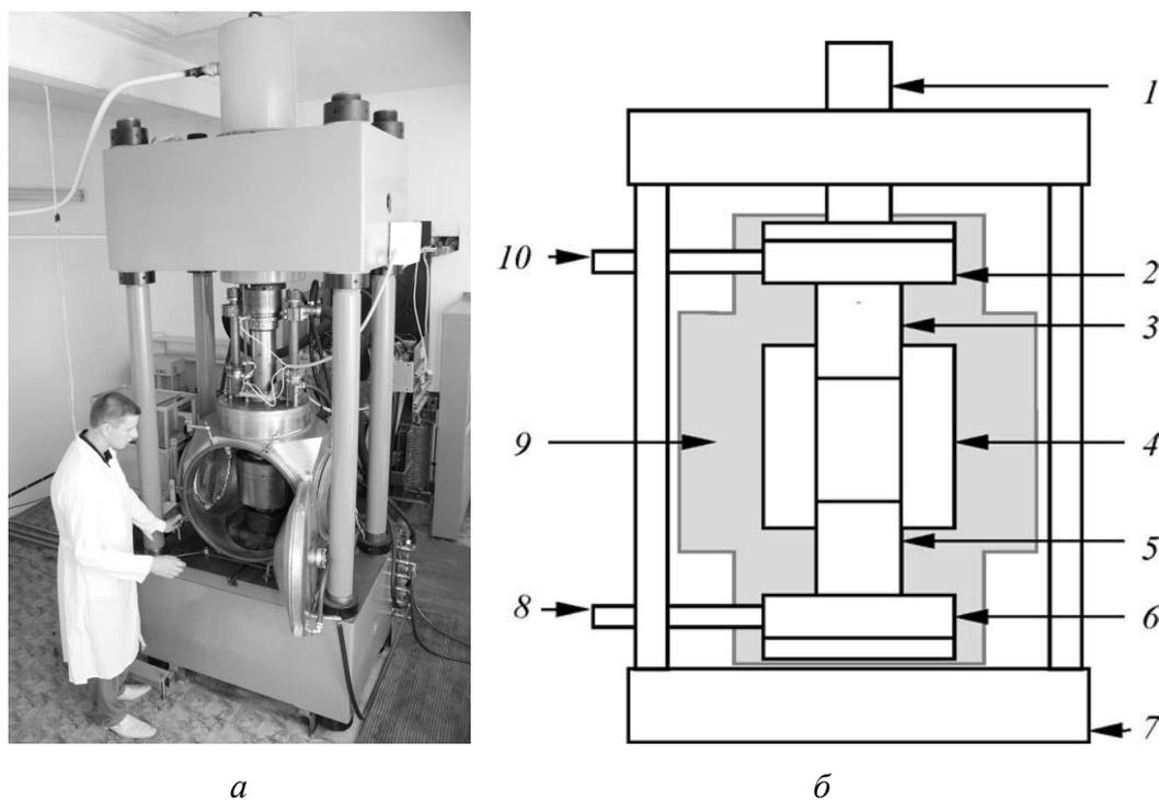
**Рис. 1.** Внешний вид (а) и схема (б) пилотной установки электроконсолидации : 1 – гидроцилиндр; 2, 6 – верхний и нижний водоохлаждаемые токовводы; 3, 5 – верхний и нижний пуансоны; 4 – пресс-форма; 7 – станина пресса; 8, 10 – кабель электропитания; 9 – вакуумная камера
